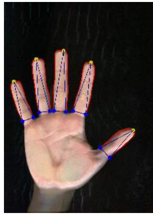
(e) Wykrycie punktów reprezentujących koniuszek palca poprzez wpisanie trójkąta o największej powierzchni w palce.
